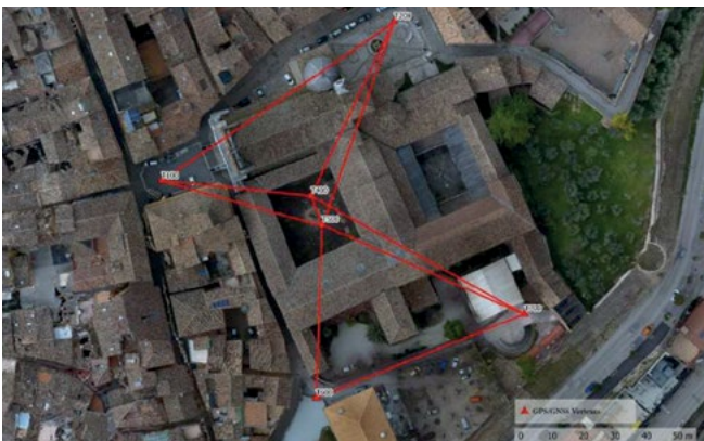
Figura 8. Rete topografica principale determinata con tecnica GNSS, che abbraccia l'intero complesso architettonico, sul limitare delle mura della città.
