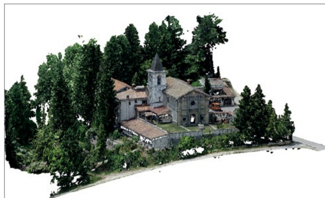
Figura 8. Visualizzazione del modello di punti generato dal processo fotogrammetrico applicato alle immagini riprese dal drone.
