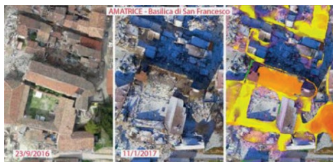
Figura 6. Analisi di change detection eseguita sui DSM delle epoche 23 settembre 2016 e 11 gennaio 2017 di Amatrice; il risultato è visualizzato sulle rispettive ortofoto, nell'area della basilica di San Francesco.
