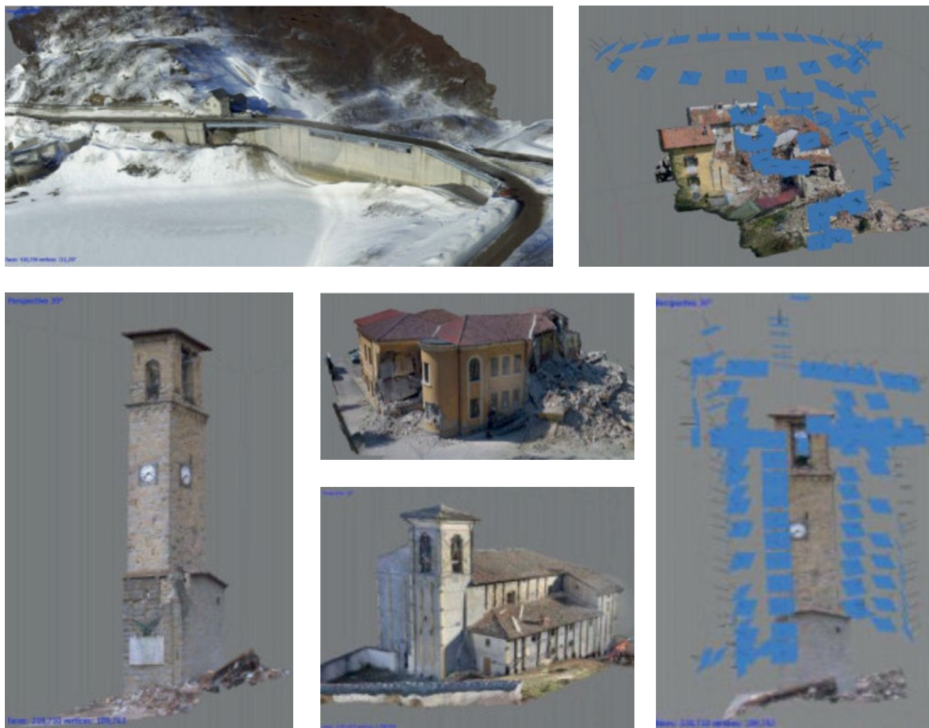
Figura 8. Modello 3D della diga di Campotosto ed elaborazione di numerosi modelli 3D di chiese o complessi monumentali con sperimentazione di voli eseguiti in modalità manuale, automatica o semiautomatica.
