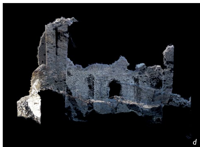
Figura 7. Documentazione da UAV per ispezionare e per mappare le rovine di Amatrice (15 febbraio 2017): (a) fotogramma nadirale sull'abitato; (b) fotogramma nadirale sulla chiesa di Sant'Agostino; (c) modello fotogrammetrico 3D sezionato per evidenziare le murature rimaste in leggero elevato; (d) una vista 3D della nuvola fotogrammetrica che evidenzia il distacco, in assenza di ammortature, della muratura della navata e del campanile della chiesa di Sant'Agostino.
