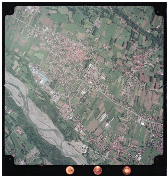
Figura 1. Esempio di immagine aerofotografica zenitale. Le dimensioni totali sono circa 23 x 23 cm. La banda laterale riporta, tipicamente: il numero del fotogramma, la quota di volo, una bolla per la verifica dell'orizzontalità, l'orologio e, talvolta, la data della ripresa.
