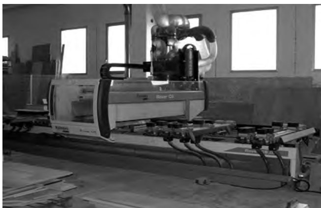
Figura 6. Lavorazione a controllo numerico. Questi centri di lavoro, sempre più diffusi nelle aziende del settore, danno la possibilità di offrire un miglior servizio al cliente. Gli stessi centri sono utilizzati anche per realizzare i moderni pannelli pantografati, destinati al settore dei serramenti.
