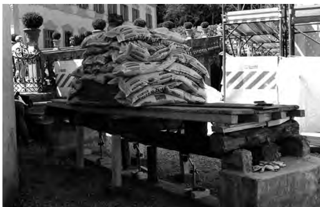
Figura 4. Villa Della Porta Bozzolo, Casalzuino, Varese: prove di carico: fase di carico su trave campione.
