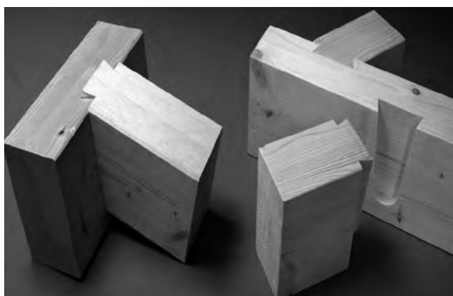
Figura 6. Lavorazione a controllo numerico. Questi centri di lavoro, sempre più diffusi nelle aziende del settore, danno la possibilità di offrire un miglior servizio al cliente. Gli stessi centri sono utilizzati anche per realizzare i moderni pannelli pantografati, destinati al settore dei serramenti.
