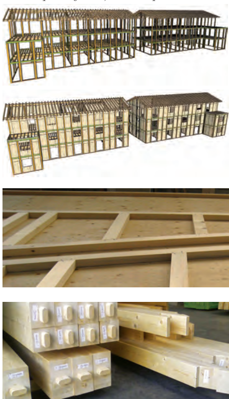
Figura 2. a) progetto delle strutture portanti; b) progetto dell'edificio. c) telaio del pannello su banco di produzione; d) strutture portanti.
