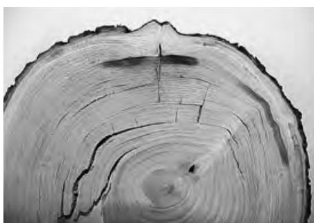
Figura 3. Dettaglio di cipollatura del tipo a frattura. Tratto da: Fonti, Giudici, Conedera 2002
