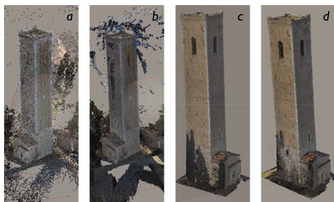
Figura 2. Modello fotogrammetrico 3D: (a) nuvola sparsa; (b) nuvola densa; (c) nuvola densa dopo il processo di pulizia e riduzione rumore; (d) modello 3D texturizzato.
