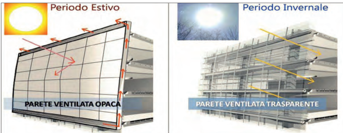
Figura 4. Trasmissione del calore attraverso componenti opachi di involucro.
